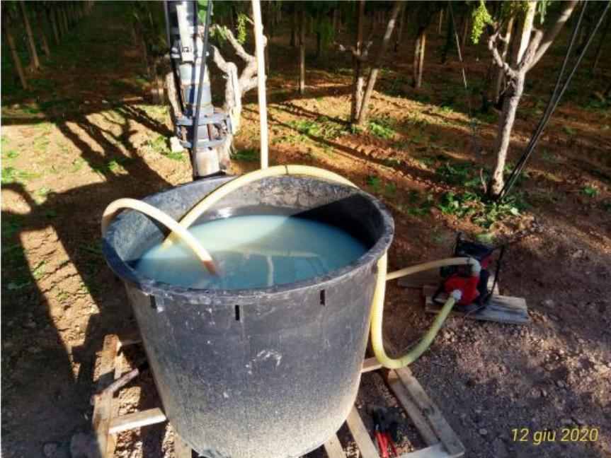
Sistema aziendale di fertirrigazione con mastello in plastica da 350 litri in cui solubilizzare i fertilizzanti e motopompa per iniettare la soluzione nell'impianto di irrigazione
